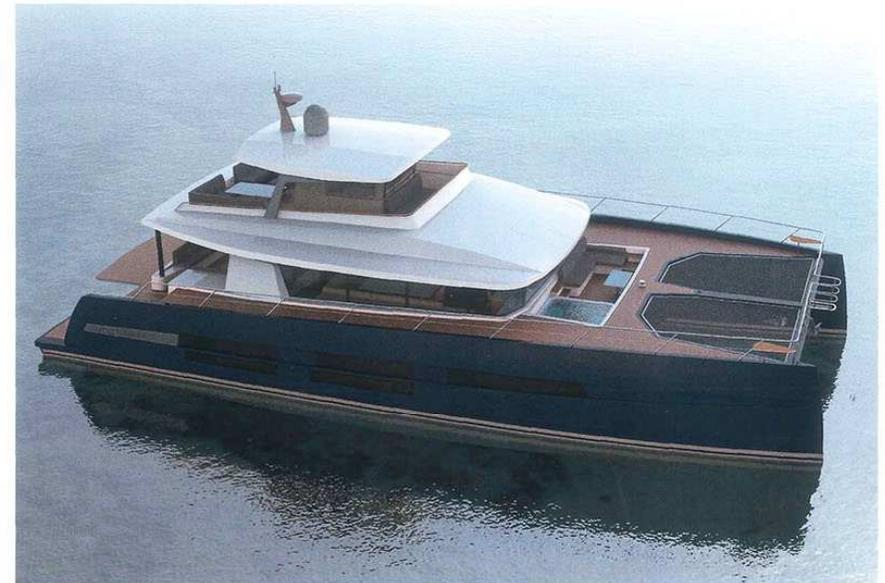
Le long Island 78, du chantier JFA basé à Concarneau (29). Ce catamaran hauturier est construit en aluminium pour les coques avec un pont en composite. Darnet Design a conçu l'intérieur de ce bateau de propriétaire.
